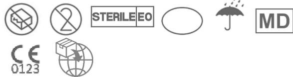
Kennzeichnung auf allen Verpackungsebenen mit CE und nach DIN EN ISO 15223-1 und DIN EN ISO 20417.
